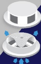
· Válvula de exhalación que disminuye sensiblemente la condensación como efecto de la exhalación de aire caliente.
